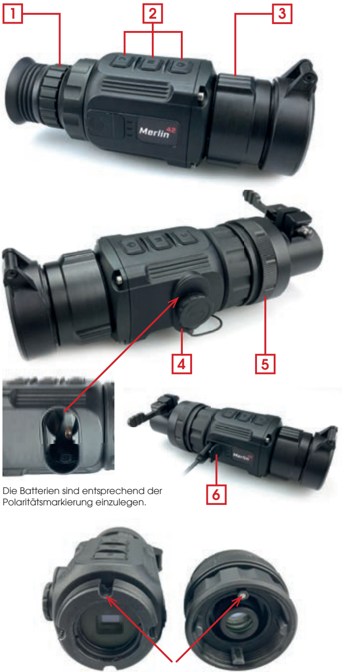
Bei der Adaption der Kollimatorlinse ist darauf zu achten, dass der runde metallische Zapfen in die runde Nut des Gewindes geführt wird. Nur in dieser Position lässt sich die Linse anschrauben!
